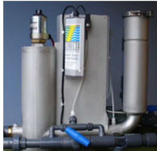
Heizung mit Begrenzer 230V Ozonator mit UVC 20000 h Venturi Injektor (automatisch) Peristaltikpumpe für H2O2
